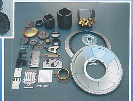
Blechstanz-, Zieh- und Prägeteile Blechteile von Stanzautomaten bis 100 to mit Oberflächen
